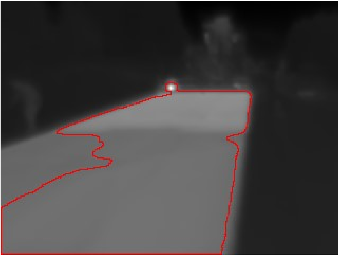
Figure 4.4 – Mauvaise séparation où une partie de la zone d'intérêt est ignorée.
