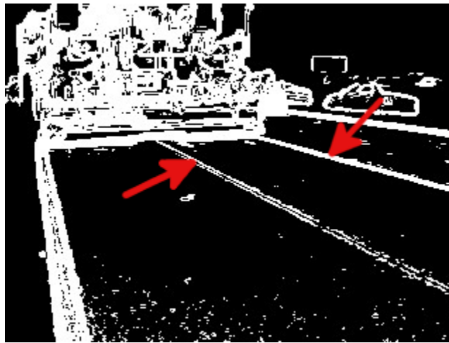
Figure 2.11 – Module du gradient d'une image infrarouge de l'enrobé bitumineux. Deux axes pouvant permettre une séparation y sont indiqués par des flèches rouges.
