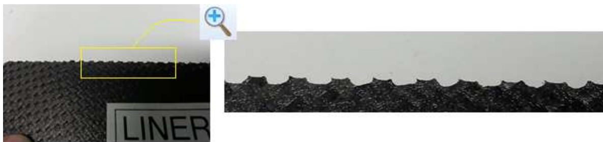
Figure 1. 3 - Peau de liner en fibre de carbone découpée à Hydrocoupe THP Inc. au jet d'eau
