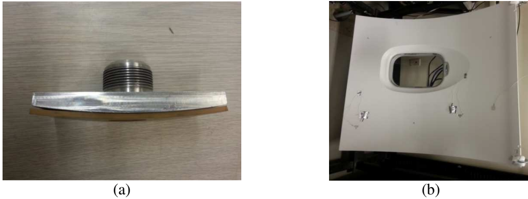
Figure 3. 25-Panneau concave mesuré avec un adaptateur de rayon 25.5'' (a) Adaptateur convexe de rayon 25.5'' – (b) Panneau concave de rayon 35.4''
