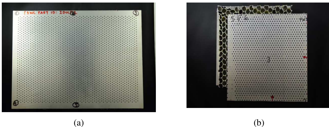
Figure 3. 12 - Échantillons de liners fournis par PWC (a) IDUCT 1 (b) SF6
