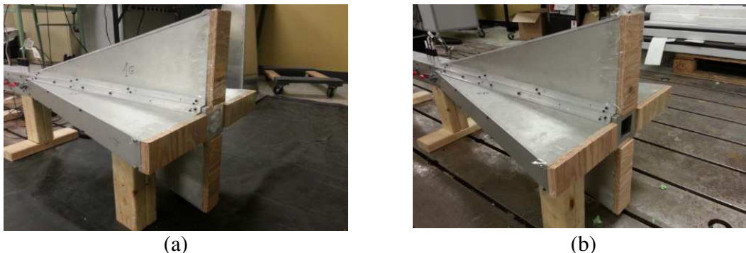
Figure 6. 13 – Terminaison étudiées (a) Terminaison remplie de polyester – (b) Terminaison sans polyester
