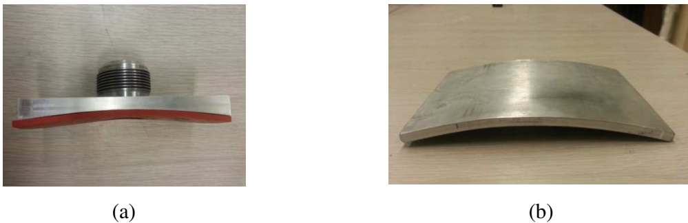
Figure 3. 29-Surface convexe rigide mesurée R= 15" avec un adaptateur concave R= 15"
