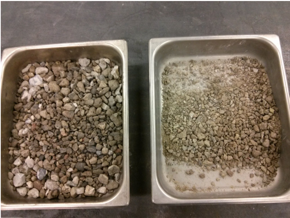
Figure 21: MR-2 après méthode de gel/dégel
