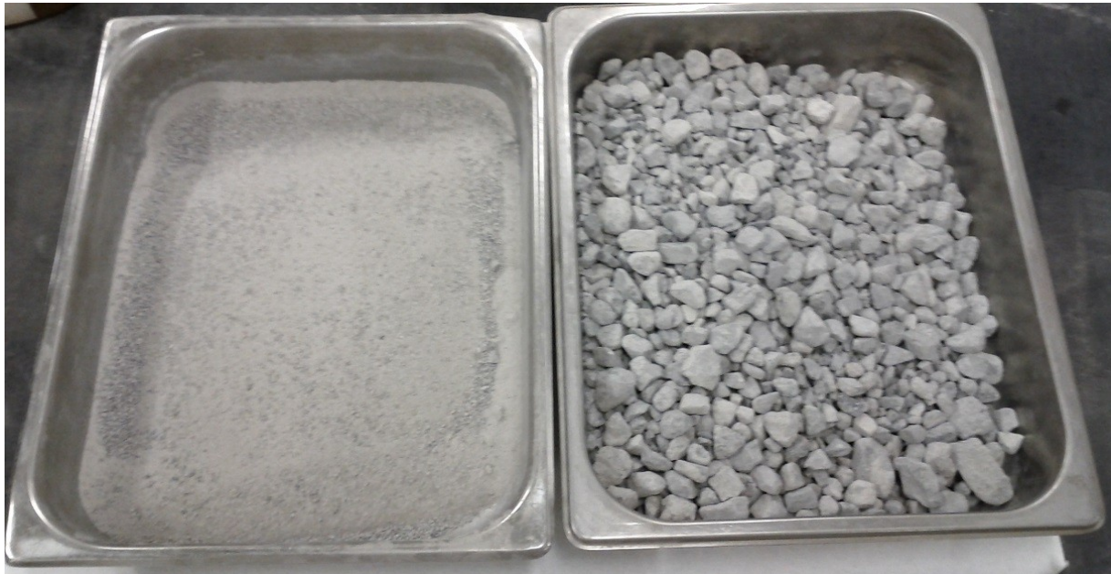
Figure 18: MR-2 après essai Los Angeles
