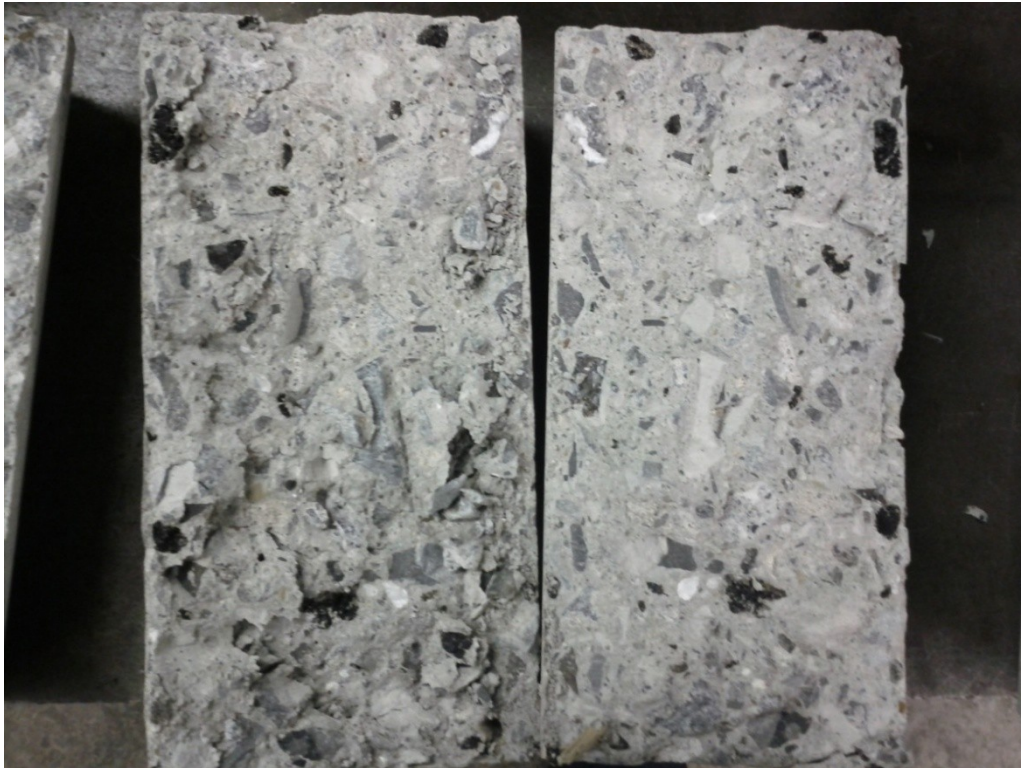
Figure 38: Éprouvette de béton R-0,65-50% suite à l'essai Brésilien
