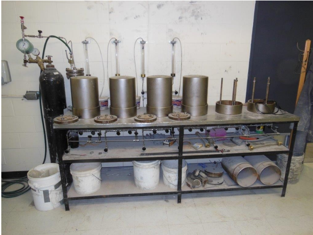
Figure 37: Montage expérimental de l'essai de perméabilité à l'eau
