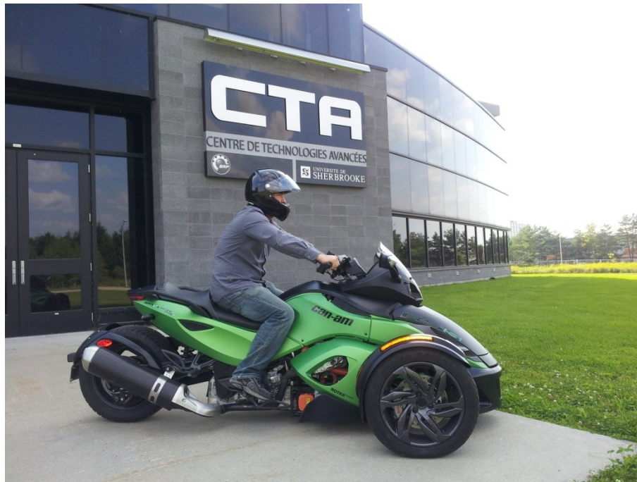
Figure 5.11 Prototype expérimental du VEHR à trois roues
