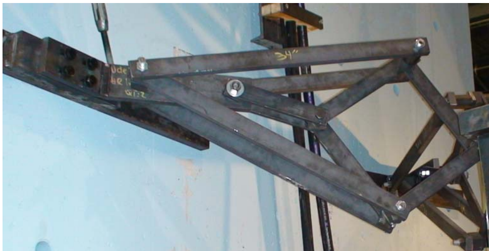
Figure 5-9 : Dispositif de Peaucellier
