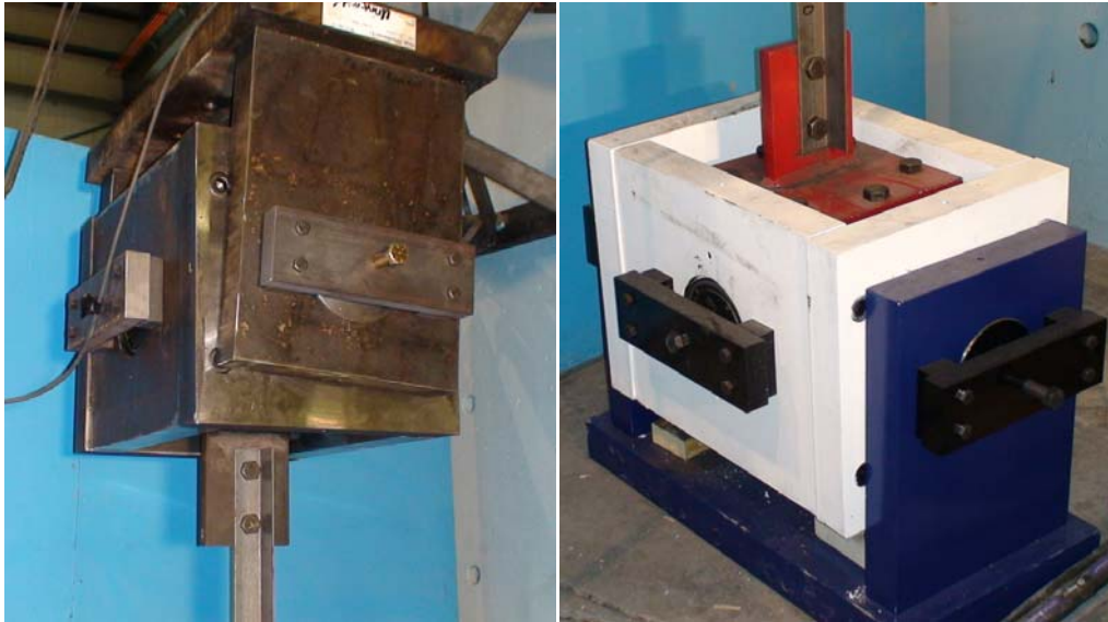
Figure 5-8 : Rotules utilisées aux extrémités du montage de traction/compression
