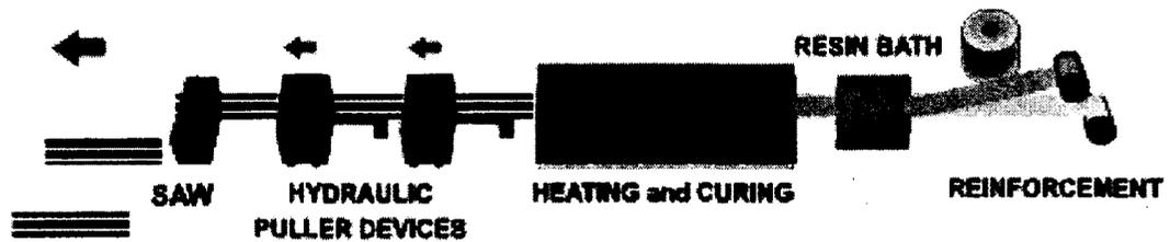
Figure 2.11 : Procédé de pultrusion [Pultrall, 2009]
