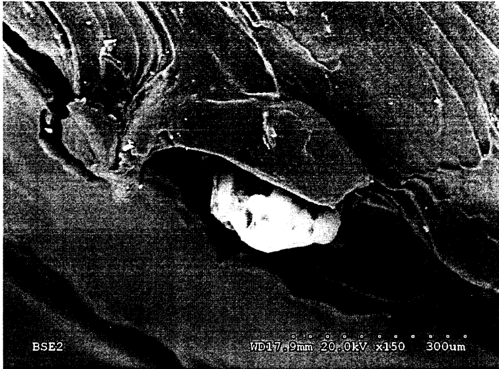
Figure 3.7 - Observation au MEB d'un granulé de composite LLDPE-Verre-TiO 2 3 %. Grossissement x150, échelle 300 microns.
