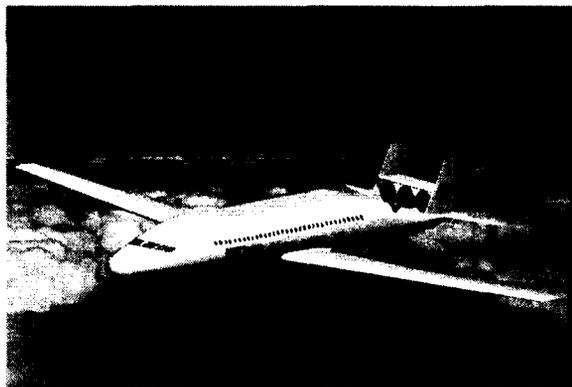
Figure 2.4 Effets d'installation des moteurs au dessus de l'aile.
