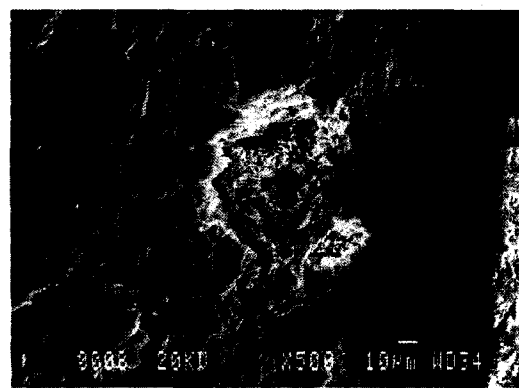
Micrographe A12- Remplissage d'une bulle d'air entraîné par de l'ettringite; qui semble important.
