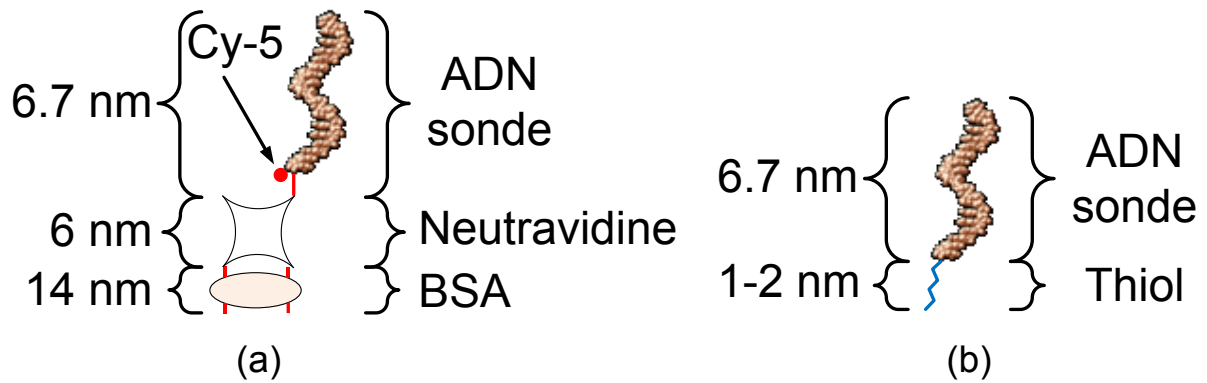
Figure 3.8 a) Schéma du biorécepteur tel que choisi avec la hauteur des différentes parties b) Schéma de la fonctionnalisation de l'ADN à l'aide de thiol. La comparaison entre les deux techniques nous montre bien que la fonctionnalisation à l'aide de BSA-Neutravidine soulève à 20 nm le brin d'ADN de la surface d'or versus 1 à 2 nm à l'aide de la fonctionnalisation à l'aide de thiol
