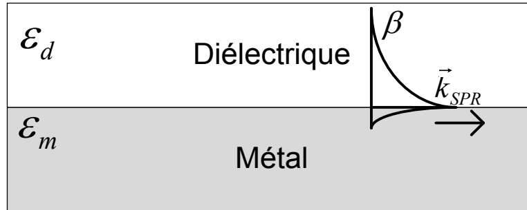
Figure 2.13 Représentation de l'onde évanescence SPR à l'interface métal/diélectrique
