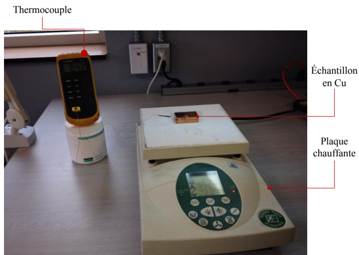
Figure 5.15 Montage de mesure de la variation de température de la plaque chauffante et du bloc de cuivre
