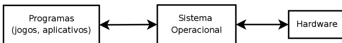
Figura 1: Interação com o hardware através do sistema operacional
