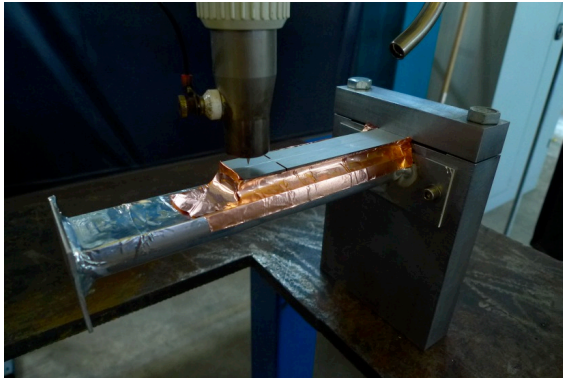
Figure 1 : montage pour l'essai JWRI
