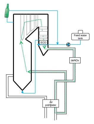
Figure 2: "Studstrupværket" boiler, schematic
