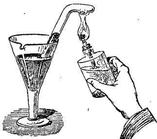
Fig. 151. — Analyse du phosphure gazeux d'hydrogène.
