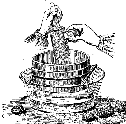
Fig. 420. — Extraction de la fécule de pomme de terre.
