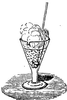
Fig. 269. — Action de l'acide azotique sur le cuivre.
