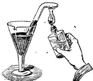
Fig. 186. — Analyse de l'acide sulfhydrique.
