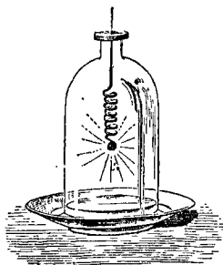
Fig. 254. — Combustion du fer dans l'oxygène.
