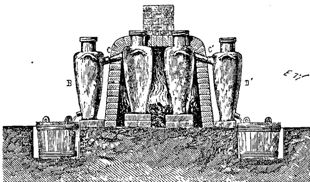
Fig. 157. — Extraction du soufre natif par distillation, à Pouzzoles.
