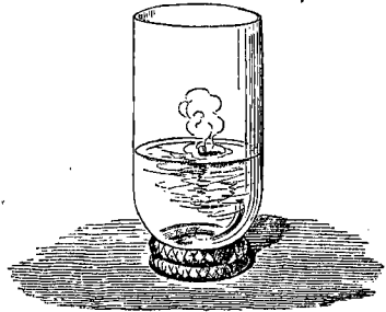
Fig. 274. — Action du potassium sur l'eau au contact de l'air.
