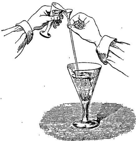
Fig. 290. — Combustion du phosphore sous l'eau par le chlorate de potasse et l'acide sulfurique.
