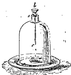
Fig. 386. — Oxydation de l'alcool par le noir de platine.
