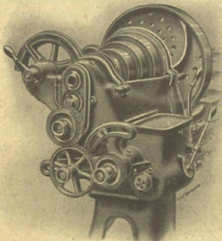
Fig.14. — Lyre du tour Perfecta ; ici le changement de marche avec débrayage par engrenages commandant les pignons pour le filetage est enfermé dans la poupée fixe.
