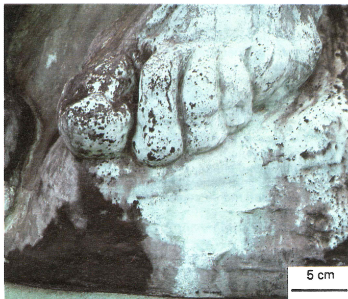
Figure 1b. — Aspect des altérations de surface. Au centre, zone vert clair. An niveau des doigts de pied et à droite du cliché, zones noires sous forme d'îlots ou de « zébrures ». A gauche, zone protégée de l'action lessivante des eaux de pluie, zones noir « mat » et verte. Pied du Penseur, Musée Rodin, Paris.
