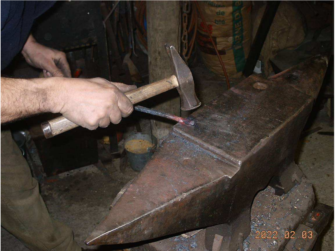
E - Enroulage de la douille
