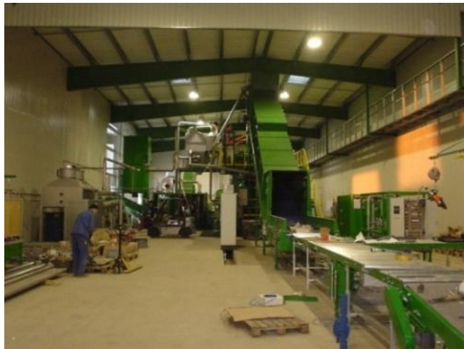
Figure 48: Convoyeur avec les stations de dépollution
