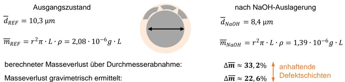
**Abbildung 4-82:** Vergleich von E-Glasfasern ohne Binder vor und nach alkalischer Auslagerung bezüglich Durchmesser und Masseverlust.
