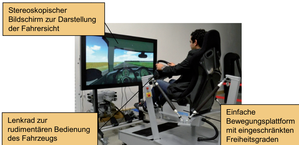
Bild 25: TRAFFIS portable Version mit reduzierter Modellierungstiefe und eingeschränkter Ausprägung der Lösungselemente nach [HBA+13].
