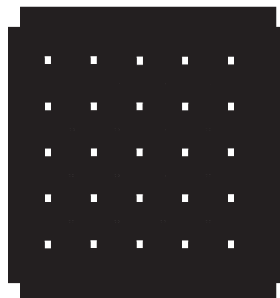
Abbildung 5.18: Maskenvorlage für die Herstellung der dünnen SiO 2 /SiON-Membran
