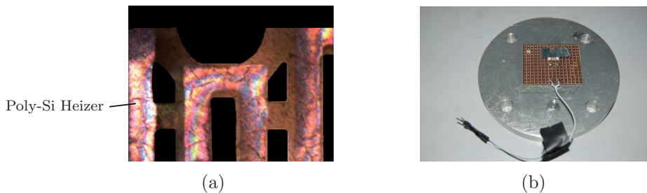
Abbildung 5.24: (a) Ausschnitt der hergestellten Heizstruktur für die elektrothermische Ausdehnung der Membran und (b) präparierter Chip für die Charakterisierung
