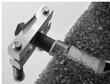
Abbildung 6.6: Versuchsmotor 5, freischwingend gelagert in Schaumstoff
