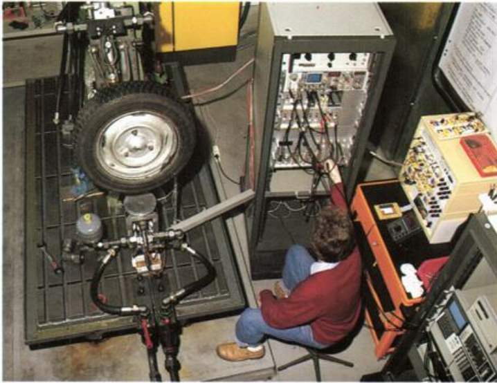
Versuchsstand für ein aktives Federbein mit hydraulischen Kraftgebern
