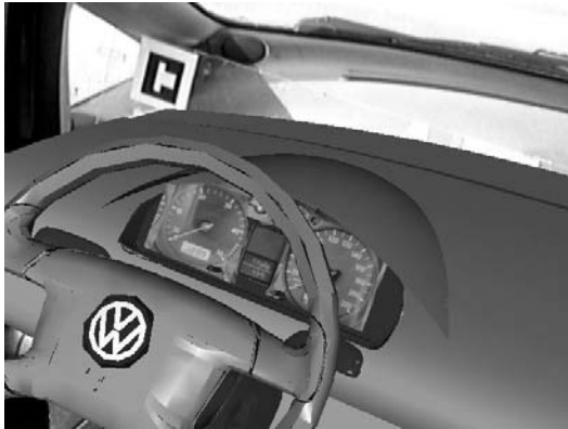
a) Einblendung einer virtuellen Konsole in einem realen Fahrzeug
