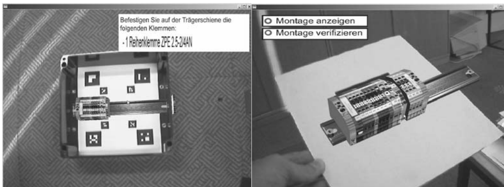
Bild 2-22: Montage von Klemmleisten in einem Schaltkasten
