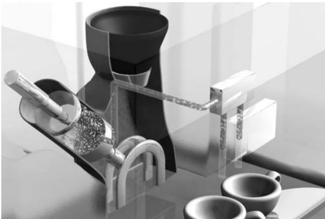
Bild 5-4: Eine Videoanimation erläutert das Funktionsprinzip des Cafevollautomaten.
