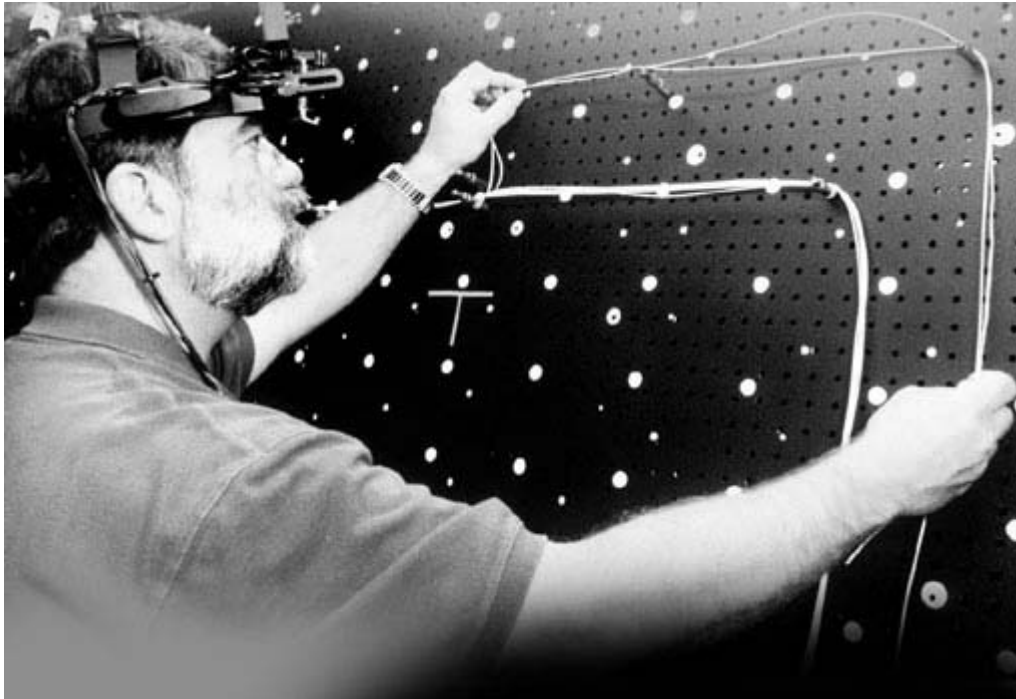
Bild 2-21: Kabelbaummontage mit AR-Unterstützung [CM92]
