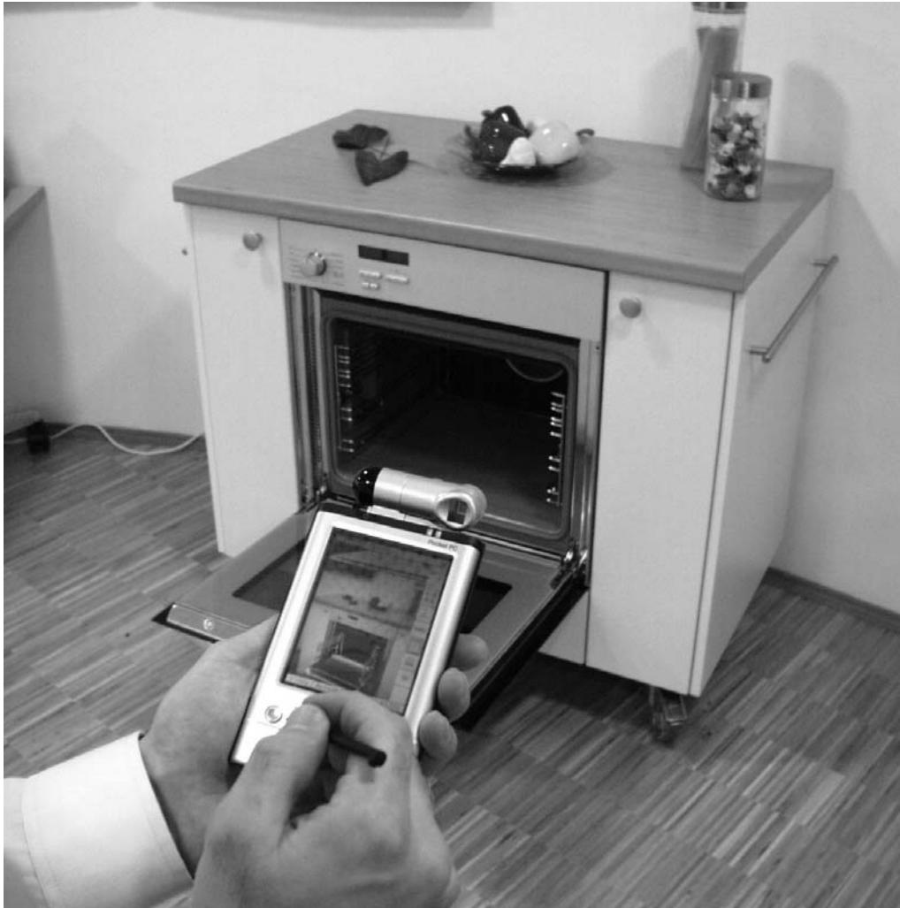
Bild 2-26: Bedienungserklärung mittels Augmented Reality
