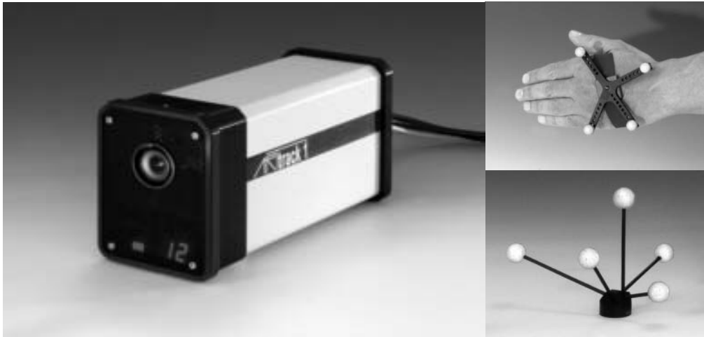
Bild 2-8: ARTtrack1: Optisches Infrarot-Tracking [ART06-01]
