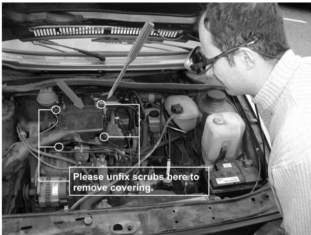
Bild 2-2: Virtuelle Informationen werden in das Sichtfeld des Monteurs eingeblendet [Gau02]
