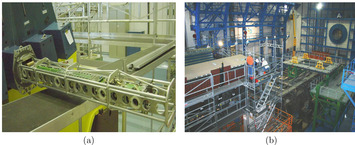
FIGURE 16 – Photographies prises lors de la construction du TileCal. (a) : Vue d'un super-tiroir dans son panier rotatif, au moment de l'insertion dans le calorimètre. (b) : Vue prise lors des tests en caverne. Au fur et à mesure que les modules du TileCal étaient descendus et assemblés, les tests sur l'électronique se poursuivaient avec MOBIDick.
