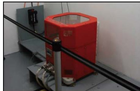
Figure 2-11: Gravimètre relatif embarqué à bord du Beautemps-Beaupré lors de la campagne Eroder 1.
