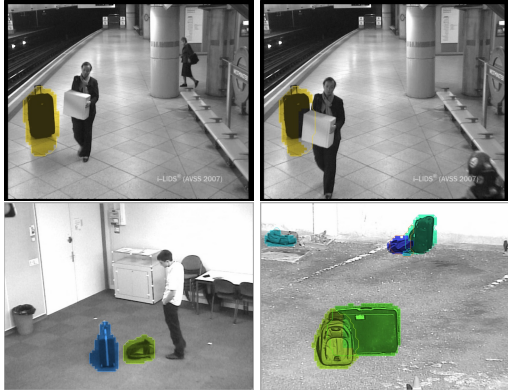
FIGURE 1 – Un masque binaire par label est utilisé. Cela permet de gérer indépendamment les différents objets.
