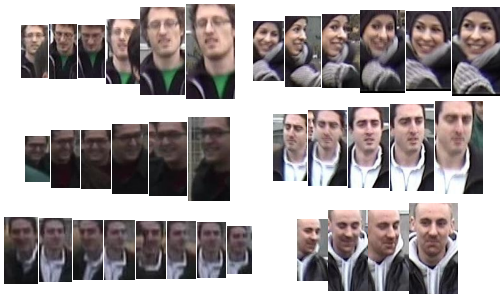
FIGURE 4 – Aperçu des détections de visages de face, obtenues avec l'implémentation OpenCV du détecteur Viola-Jones. La zone de détection est doublée vers le bas.
