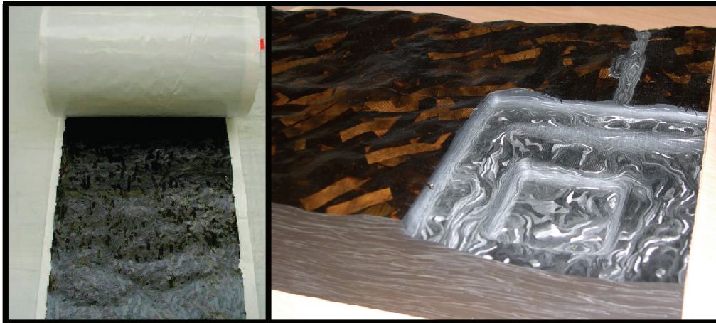
Figure 1-11: Hextool™ sous forme de préimprégnés et usiné
