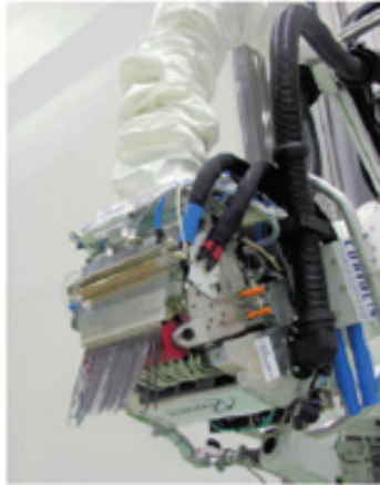
Figure 1-5: procédé de placement de fibre
