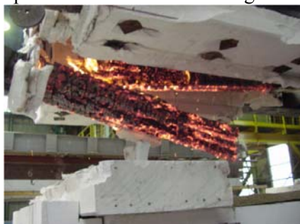
Figure C.9 : Rupture en cisaillement d'un assemblage bois-bois lors d'un essai de résistance au feu
