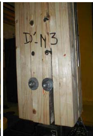
Rupture par cisaillement de file
