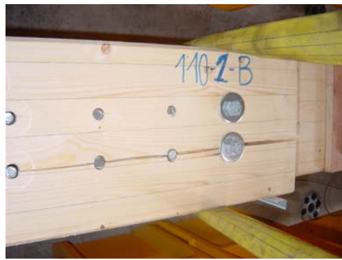
Rupture par cisaillement de file
