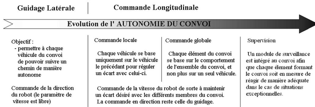
FIG. 2.2 – Démarche adoptée pour la mise en œuvre de la commande du convoi autonome
