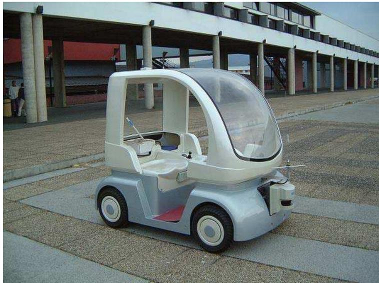
FIG. 1 – Véhicule expérimental : Cycab
