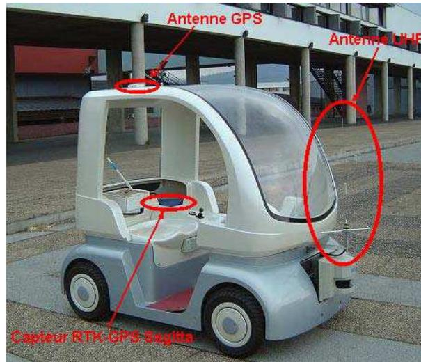
FIG. 4.5 – Implantation du capteur RTK-GPS sur Cycab
