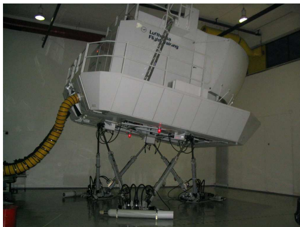
FIGURE 1.9 – Exemple d'utilisation d'un robot parallèle (plate-forme de Gough-Stewart) dans un simulateur de vol.
