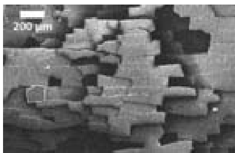
Figure II.16 – Clichés MEB de dépôts obtenus par évaporation (3,8 %, 25 °C)
