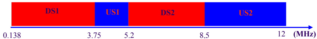
Figure I-16 : Spectre de la technologie VDSL, plan de fréquence 998
