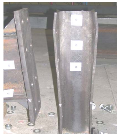
Photo 4 : Déformation des composants de l'assemblage FS4
