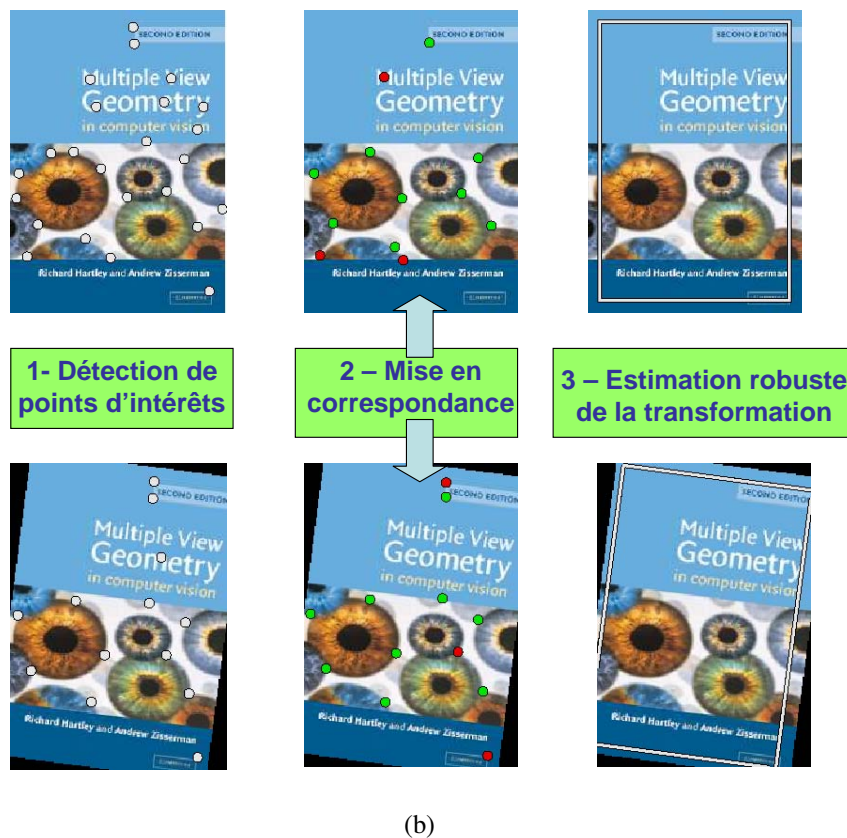
FIG. 2.5 – Principe des méthodes basées primitives de recalage d'images. (a) Illustration du critère des méthodes basées primitives. (b) Schéma récapitulatif de leur fonctionnement.
