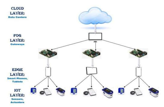
Fig. 1. IoT-Fog-Edge-Cloud Computing Integration
