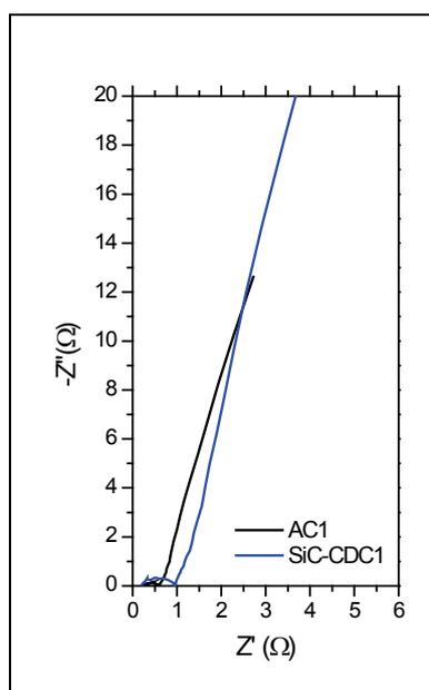
Figure 46 : Diagramme de Nyquist des échantillons AC1 et SiC-CDC1, obtenu par spectroscopie d'impédance complexe entre 10mHz et 10kHz dans H<sub>2</sub>SO<sub>4</sub> 1M après 100 cycles à 10mV.s<sup>-1</sup>
