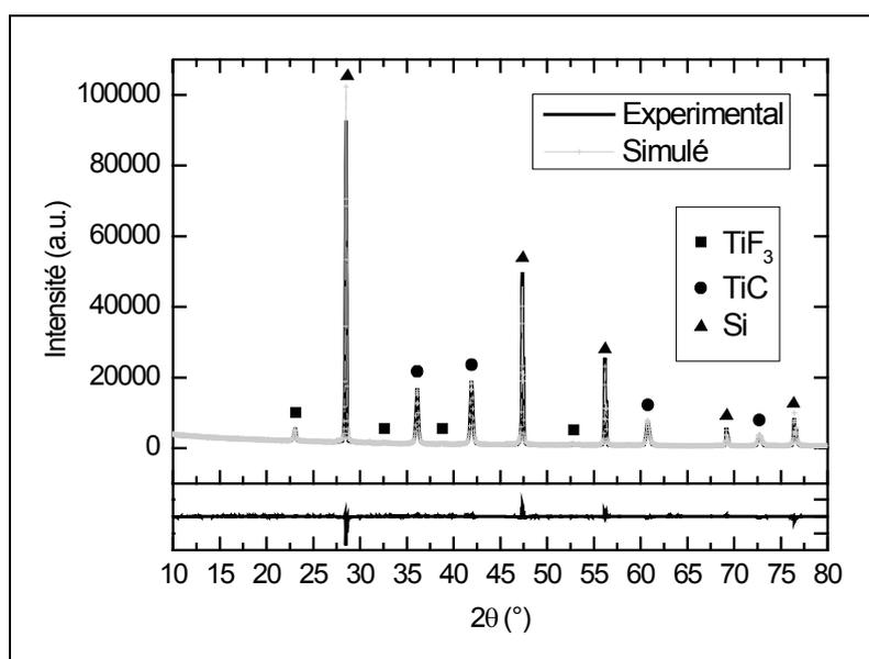
Figure 26 : Diffractogramme X après affinement de l'échantillon S5
