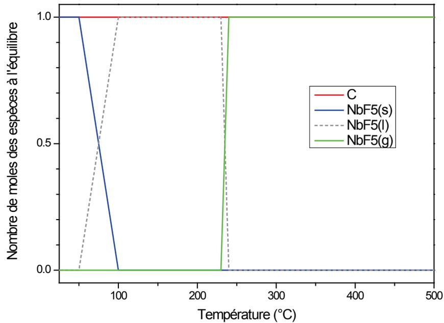
Figure 102 : Simulation thermodynamique du système 1NbC-2,5F<sub>2</sub>
