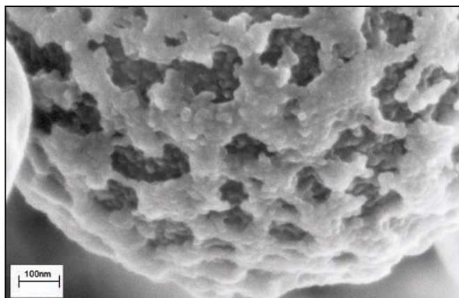
Figure 33 : Image MEB d'une sphère de l'étape 2 du mécanisme de fluoration de TiC
