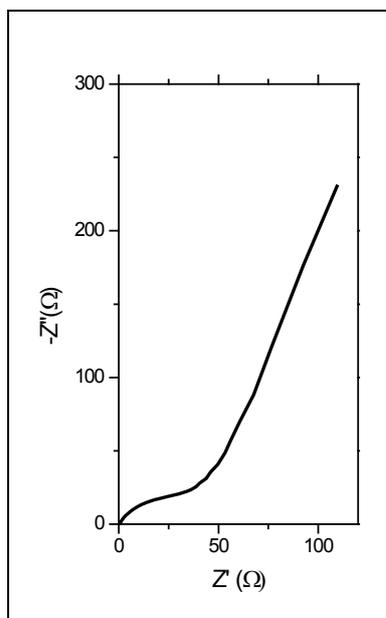
Figure 49 : Diagramme de Nyquist de S9 obtenue par spectroscopie d'impédance complexe entre 10mHz et 10kHz dans  $H_2SO_4$  1M
