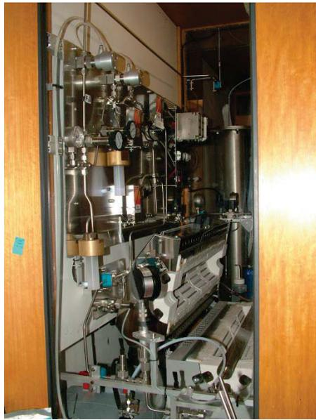
Figure 99 : Photographies du nouveau pilote de fluoration conçu dans le cadre de cette thèse
