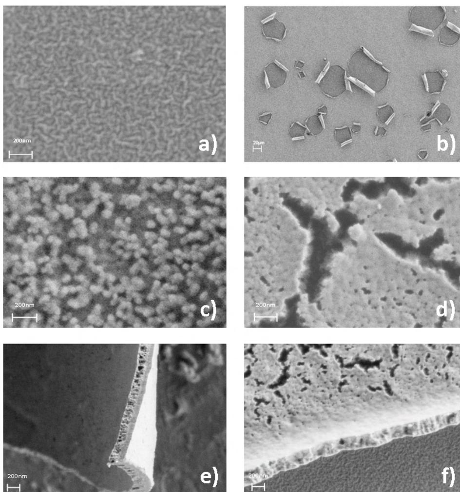
Figure 67 : Clichés MEB de a) carbure de silicium avant fluoration, b,d,f) après fluoration dynamique sous fluor moléculaire  $F_2(g)$  (4-F), c,e) après fluoration par décomposition de  $XeF_2$  (2-Xe)
