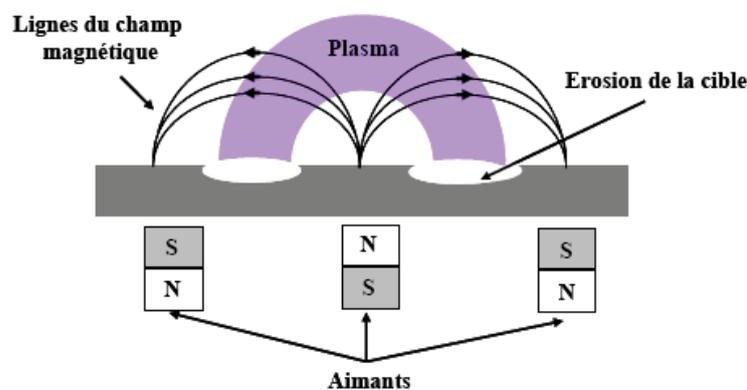
Figure 62 : Coupe schématique d'une cathode magnétron
