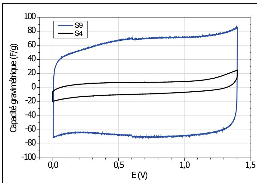
Figure 50 : Voltammétrie cyclique des échantillons S4 et S9 dans KOH 6 mol.L<sup>-1</sup> à 10mV.s<sup>-1</sup>
