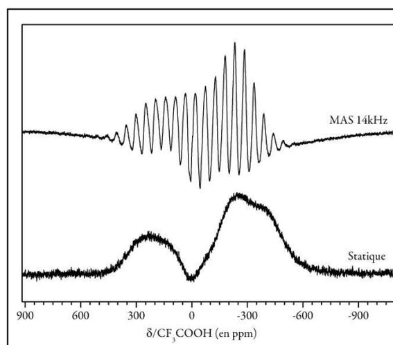
Figure 29 : Spectre  $^{19}\text{F}$  de l'échantillon S5 en statique et en MAS à 14kHz
