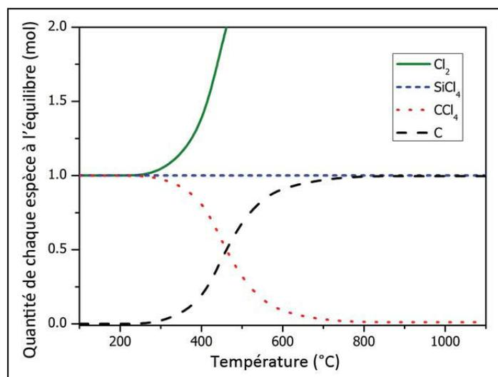
Figure 55 : Simulation thermodynamique du système SiC-5Cl<sub>2</sub>
