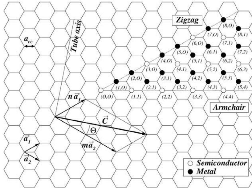
Figure 4 : Définition d'un vecteur d'enroulement  $C$  d'un nanotube (2,4) à partir des vecteurs unité  $\vec{a}_1$  et  $\vec{a}_2$  et caractéristiques des nanotubes obtenus en fonction des valeurs de  $n$  et de  $m$  [2]
