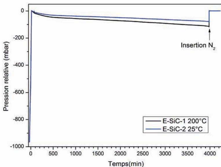
Figure 89 : Evolution de la pression intraréacteur pendant la fluoration de SiC à 1atm de F<sub>2</sub> et pour deux températures de réaction de 25 et 150°C
