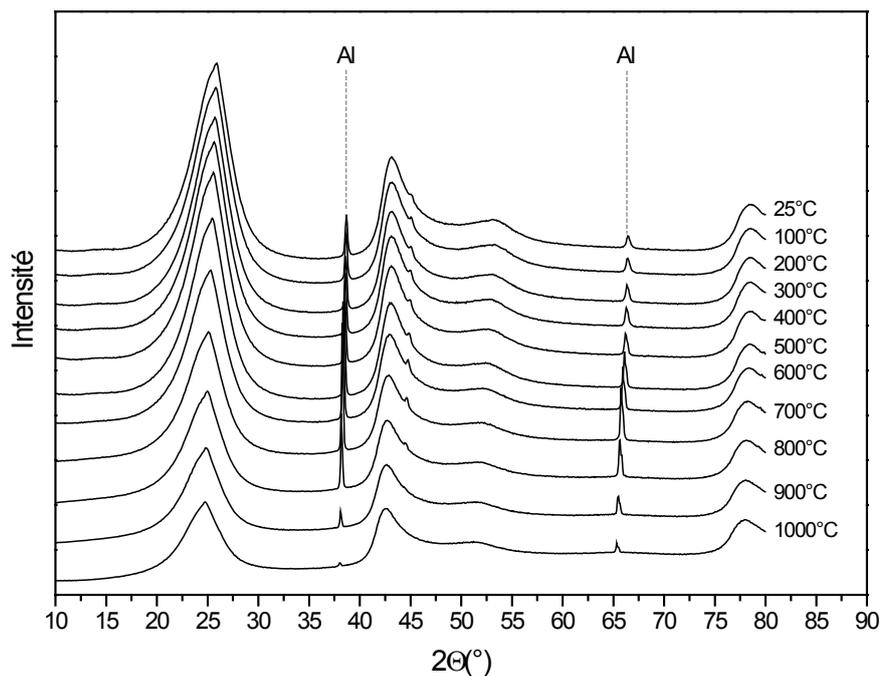
Figure 83 : Diffractogrammes X entre 25 et 1000°C sous argon avec montée en température de 5°C.min<sup>-1</sup> et palier de 1 h à chaque température
