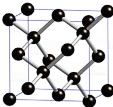
Figure 2 : Maille élémentaire de la structure diamant [1]
