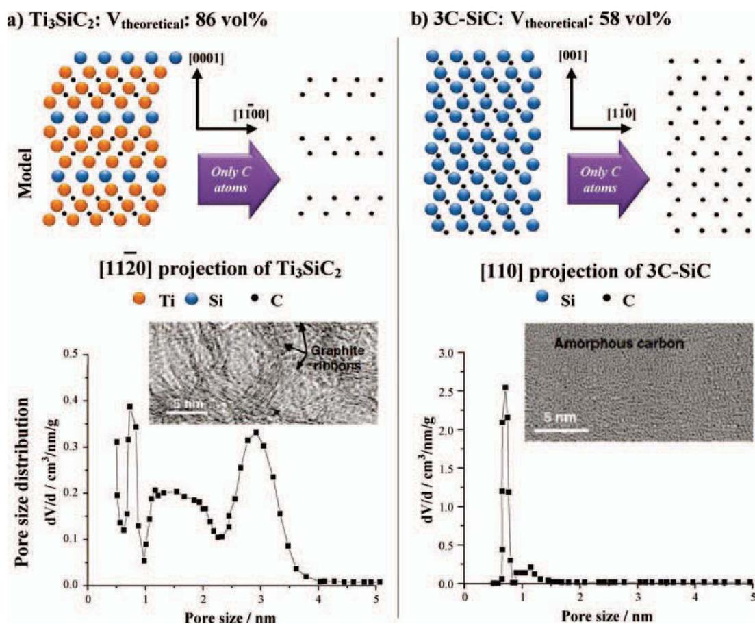
Figure 14 : Projection du plan [1120] et [110] de la structure cristallographique de (a) Ti<sub>3</sub>SiC<sub>2</sub> et (b) 3C-SiC respectivement avant et après élimination des hétéroatomes et distributions poreuses associées par NLDFT [26]
