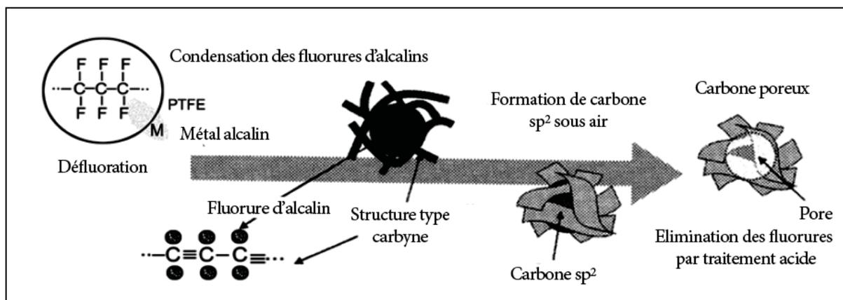
Figure 9 : Mécanisme de formation de carbone par défluoration de PTFE
