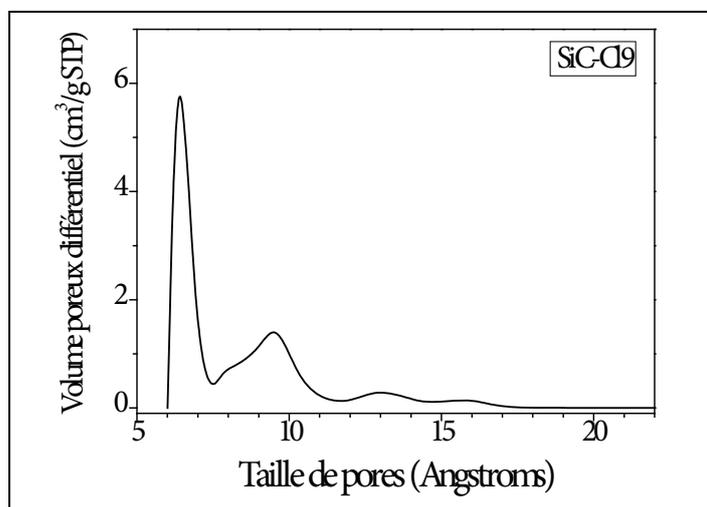
Figure 56 : Distribution poreuse par NLDFT de l'échantillon SiC-Cl9
