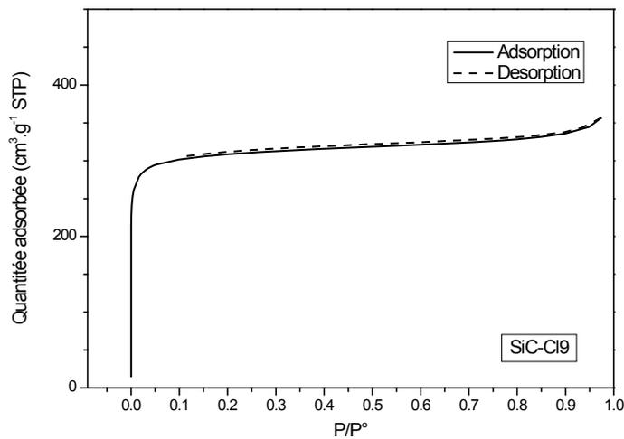
Figure 98 : Isotherme d'adsorption de N<sub>2</sub> à 77K de l'échantillon SiC-Cl9
