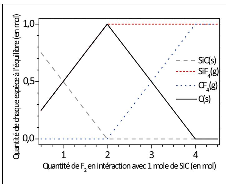
Figure 54 : Simulation thermodynamique du système SiC-nF<sub>2</sub> pour toute température comprise entre 20 et 1000°C
