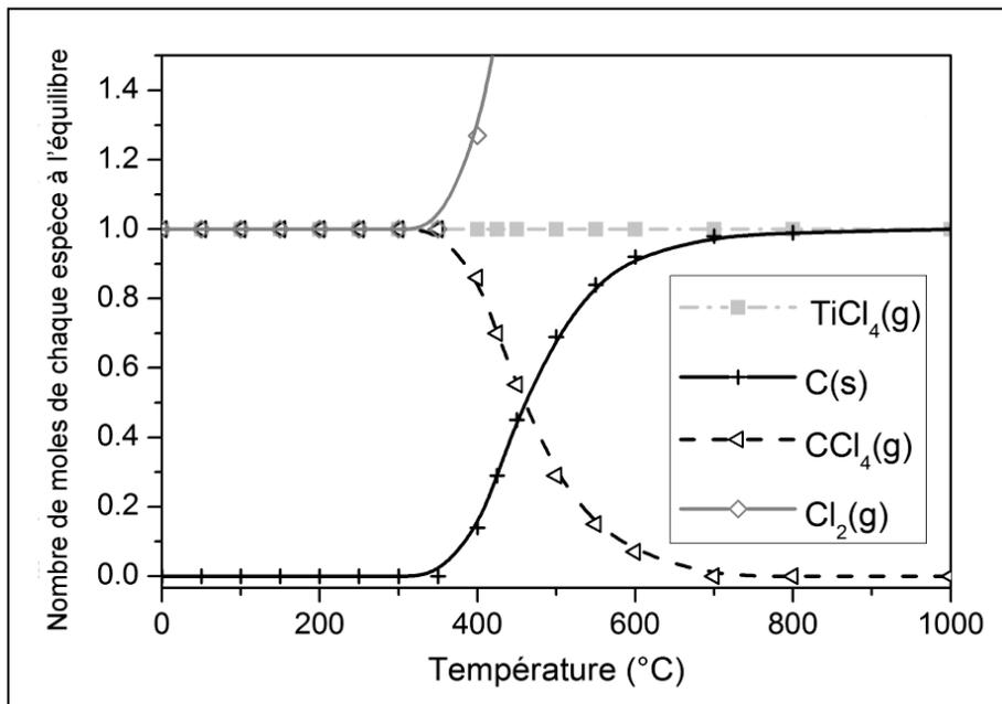
Figure 20 : Simulation thermodynamique du système TiC/5Cl<sub>2</sub>
