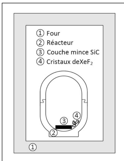
Figure 63 : dispositif de fluoration par XeF<sub>2</sub>
