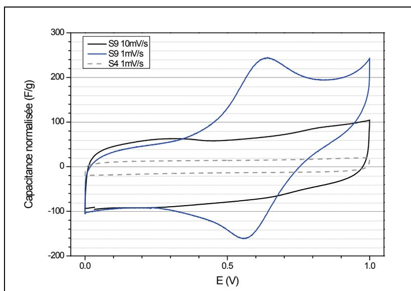
Figure 47 : Voltammétrie cyclique des échantillons S4 et S9 dans H<sub>2</sub>SO<sub>4</sub> 1 mol.L<sup>-1</sup>
