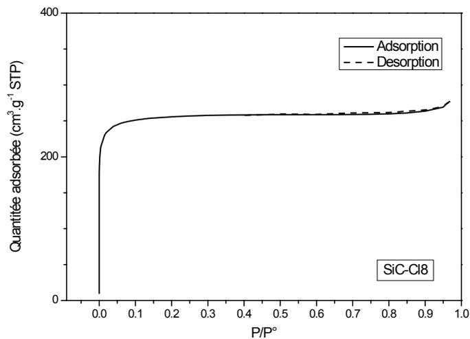
Figure 97 : Isotherme d'adsorption de N<sub>2</sub> à 77K de l'échantillon SiC-Cl8
