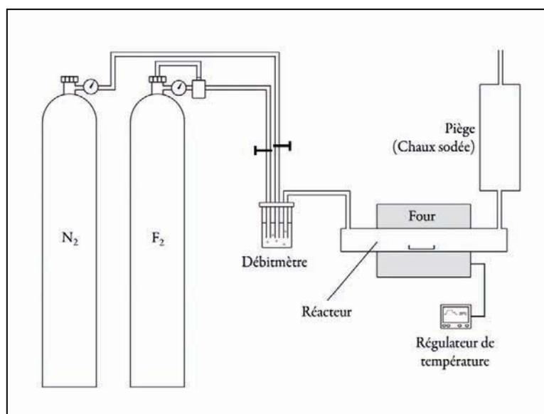
Figure 25 : Dispositif expérimental de fluoration dynamique
