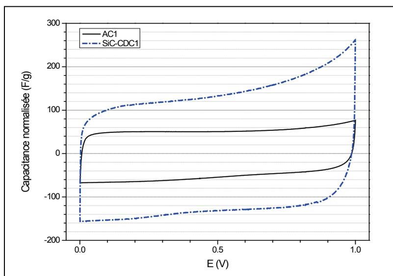
Figure 45 : Voltammétrie cyclique à  $10 \text{ mV.s}^{-1}$  de AC1 et SiC-CDC1 dans  $\text{H}_2\text{SO}_4 \text{ 1M}$  au 50<sup>ème</sup> cycle
