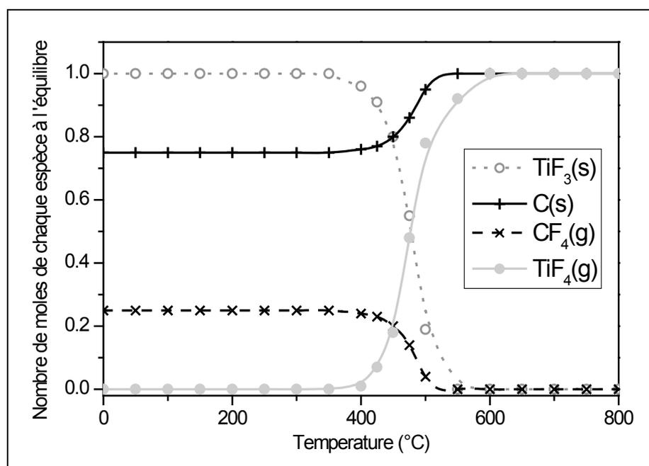
Figure 18 : Simulation thermodynamique pour le rapport  $1\text{TiC}-2\text{F}_2$  dans la gamme de température  $0^\circ\text{C}-800^\circ\text{C}$
