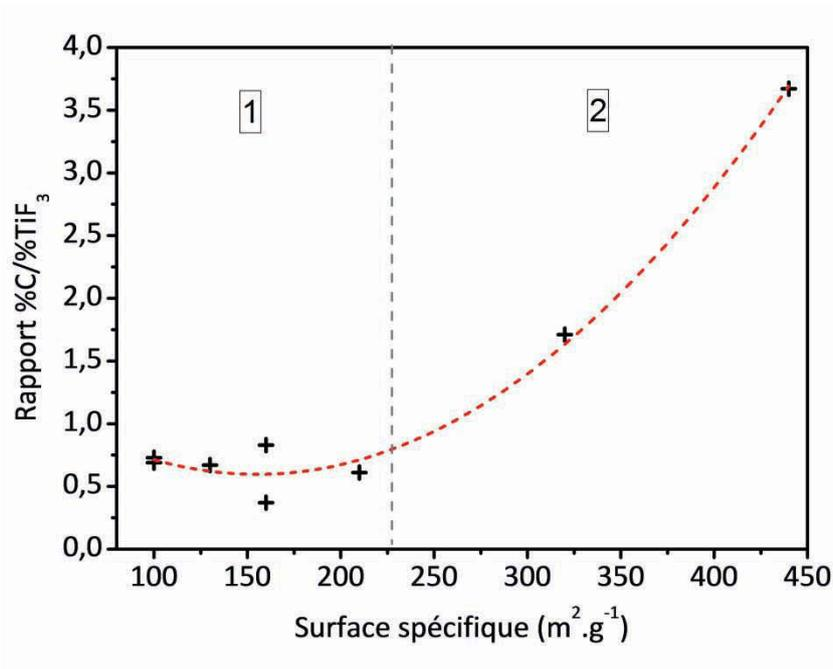
Figure 37 : Corrélation entre surface spécifique et rapport massique carbone/TiF<sub>3</sub>
