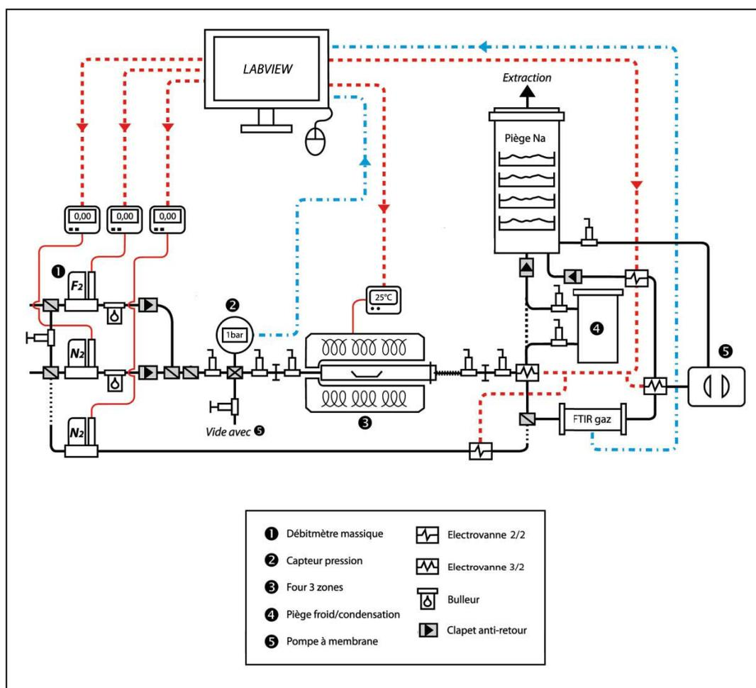
Figure 59 : Représentation schématique du nouveau dispositif de fluoration
