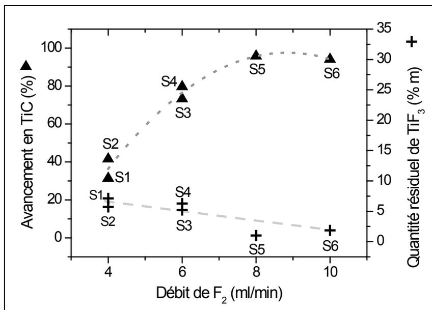
Figure 27 : Evolution de la transformation de TiC et TiF<sub>3</sub> en fonction du débit en F<sub>2</sub>
