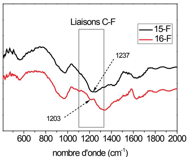
Figure 87 : Spectres IR des couches minces 15-F et 16-F avec et sans post-traitement sous N<sub>2</sub> à 200°C, respectivement
