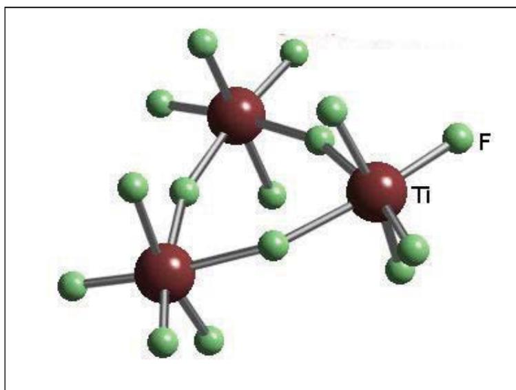
Figure 23 : Structure cristallographique du tétrafluorure de titane (ICSD #78737)
