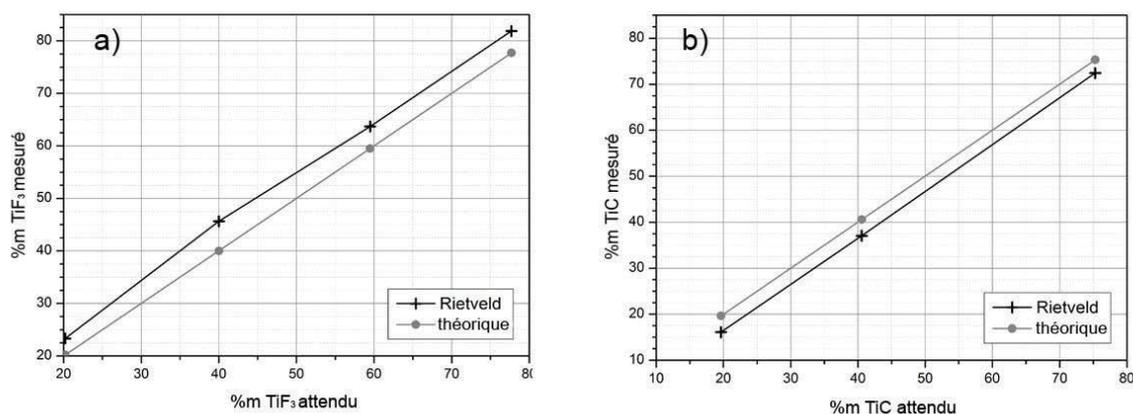
Figure 24 : Etalonnage de la quantification de chaque phase par affinement Rietveld des diffractogrammes de mélanges connus Si/TiF<sub>3</sub> (a) et Si/TiC (b)
