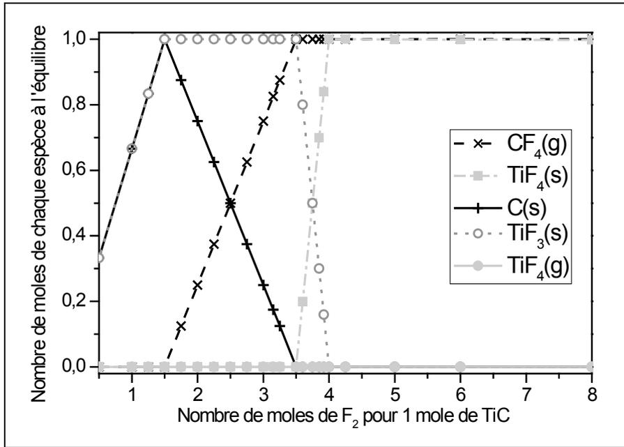
Figure 19 : Simulation thermodynamique pour le système 1TiC/nF<sub>2</sub> pour des températures comprises entre 20 et 280°C (avant la sublimation du TiF<sub>4</sub>)
