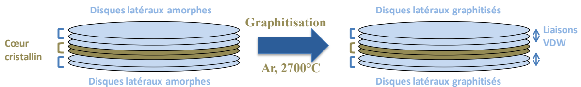
Schéma 1. Croissance des disques latéraux de part et d'autre du noyau cristallin, et effet du traitement thermique dans la graphitisation des disques latéraux
