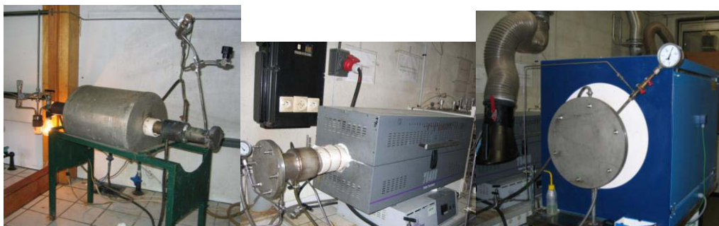
Figure 88. Photos des installations à différentes échelles : four à l'échelle de laboratoire, deux fours pour des études pré-industrielles.
