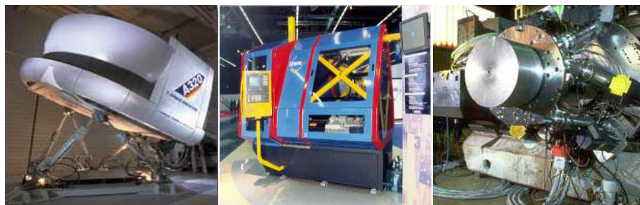
FIG. 0.1 – De gauche à droite : le simulateur de vol du centre d'entraînement de Toulouse, la machine-outil Urane SX à structure Delta (Renault Automation Comau) et la machine outil Hexapode CMW 200 pour l'usinage à grande vitesse
