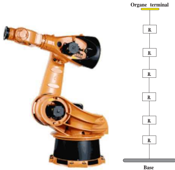
FIG. 1.1 – Robot sériel à six degrés de liberté (KUKA Robotics) (à gauche) et le graphe d'agencement (à droite)
