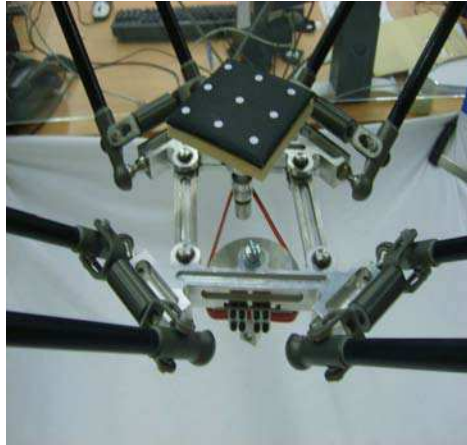
FIG. 2.41 – Observation d'une mire placée sur l'organe terminal par une caméra perspective fixe par rapport à la base
