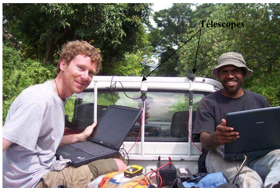
Figure 7-3. Mesures du dégazage du Yasur à bord d'un véhicule. Photo prise par J.Calkins, © IRD/P.Bani
