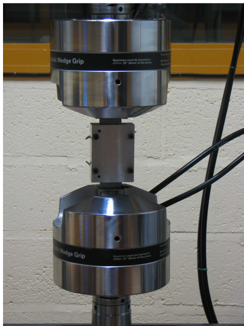
Figure 2.13 – Eprouvette équipée du raidisseur en place dans les mors hydrauliques de la machine au cours d'un essai de fatigue
