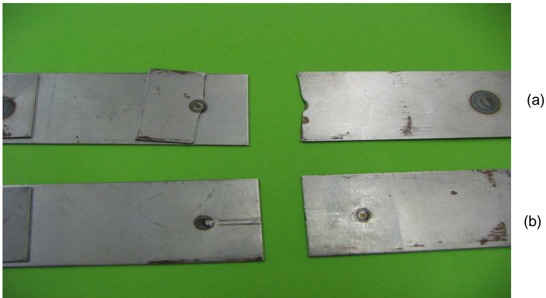
Figure 3.2 – Eprouvettes soudées par point et rompues selon deux modes distincts de rupture (a) par fissuration d'une des deux tôles, (b) par cisaillement du noyau du point soudé
