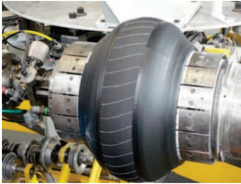
(a) Membrane de l'outillage déformée
