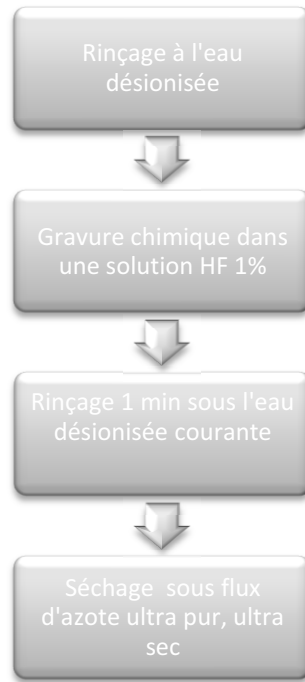
Figure 2.29. Protocole de nettoyage chimique des substrats Si/SiO 2 .
