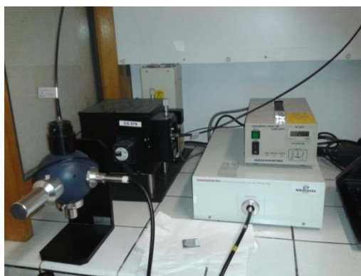
Figure II-10 : Spectrofluorimètre (HAMAMATSU Photonic Multi-Channel Analyser PMA-12).
