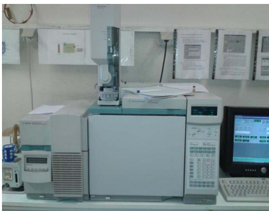
Figure II- 9 : Spectre de masse agilent 7683.
