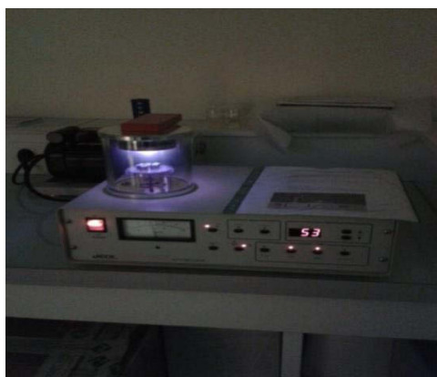
Figure II-12: Métallisation des tissus en coton par l'or dans le métalliseur JOEL JFC -1300 Auto fine coater.
