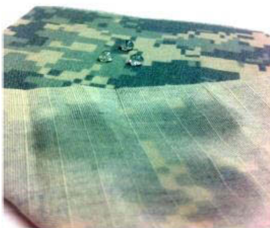
Figure I-6 : Tissu militaire hydrophile sur la face intérieure et hydrophobe sur la face extérieure.
