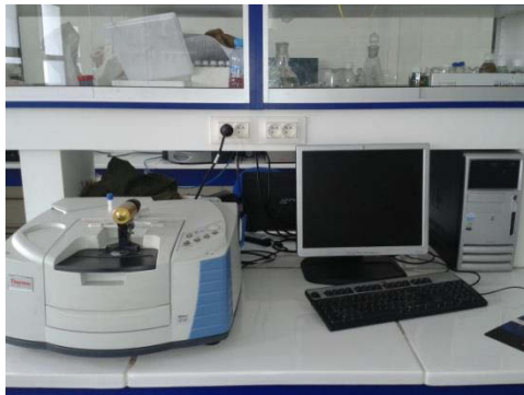
Figure II-8 : Spectromètre IR iS 10.
