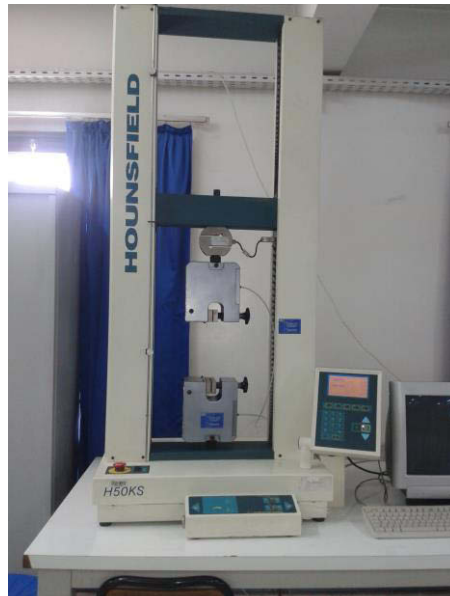
Figure II-14 : Appareil Hounsfield pour la réalisation d'essai de traction sur bandes textiles.
