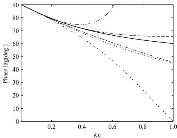
FIGURE 7. Velocity phase lag variation with Knudsen number;  $\alpha = 1.0$ . BGK solution (—); Navier–Stokes (···); Burnett (---); super-Burnett (- · -); Grad’s 13-moment (- · ·); regularized 13-moment (---).
