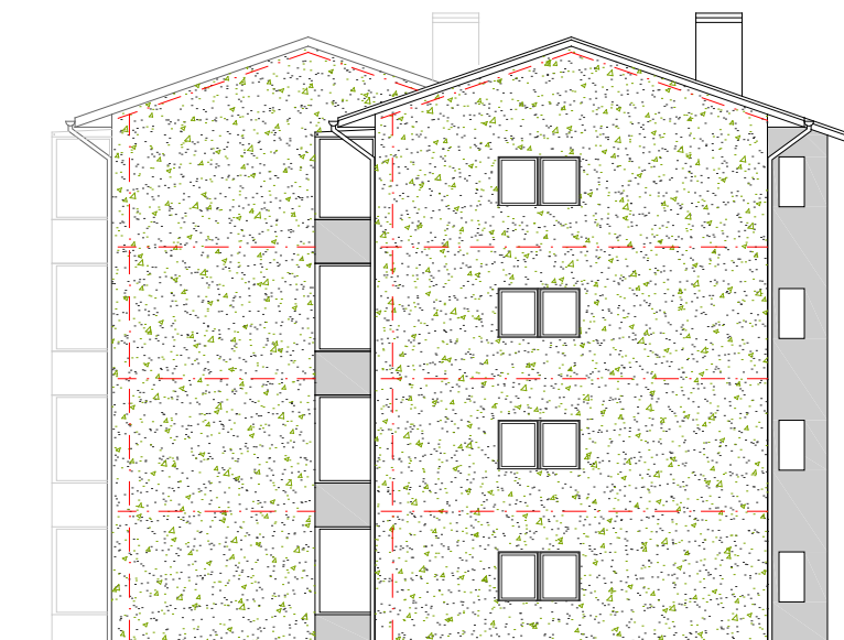
Figura 134 – Alçado Norte do bloco habitacional n.º 10 do bairro de Contumil, onde se observa os vários níveis de rega a vermelho
