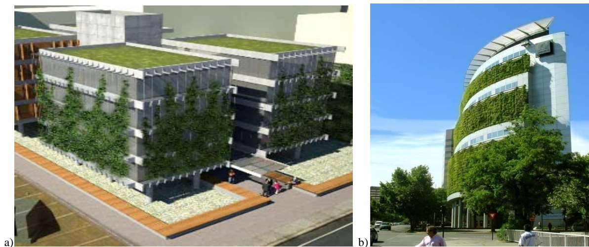
Figura 47 -Sistemas de caixa de substrato de diferentes níveis: a) 1 Nível(Retirado de: www.mixstones.com.br , 2012); b) vários níveis, como é exemplo o edifício Consórcio Sede em Santiago do Chile (Retirado de: www.plataformaarquitectura.cl )
