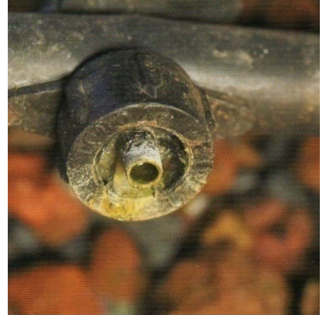
Figura 59 - Ponto de goteje com regulação, para um melhor controlo da quantidade e frequência de água usada na rega (retirado de: Groult, 2008)
