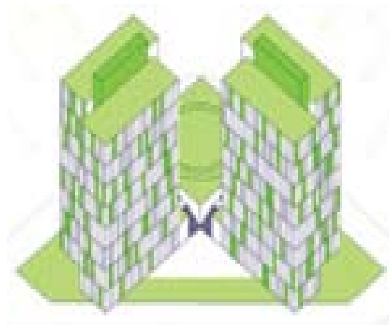
Figura 73 - desenho explicativo das Natura Towers, onde são perceptíveis os módulos de 4x1m da fachada com diferentes composições de forma aleatória (Retirado de: Baião, 2010)
