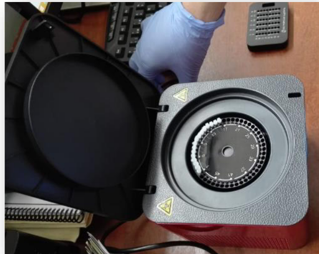
Fig. 34. 15 muestras con su respectivo control negativo y positivo en el termociclador micPCR v2.8.0.
