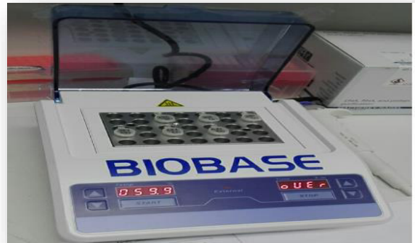
Fig.24. Desparafinación de las muestras en el Termobloque BIOBASE.
