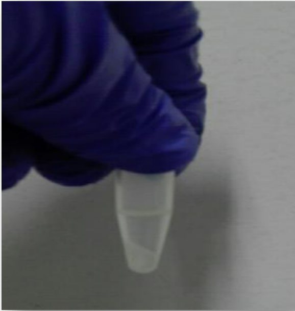
Fig.27. Parte inferior se observa una fase acuosa y en la parte superior una fase orgánica de la muestra 11.
