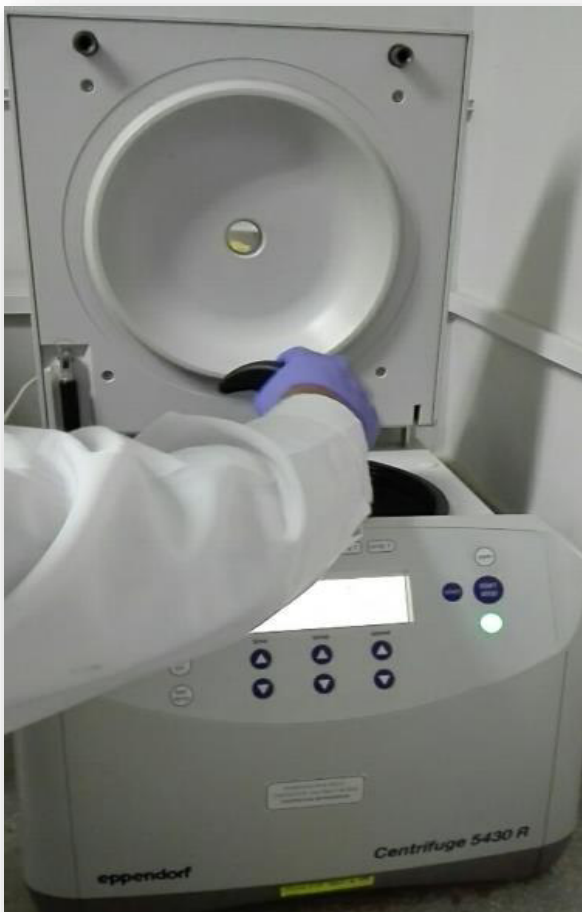
Fig.29. Centrifugando las muestras a 2.000 x g por 30 s.
