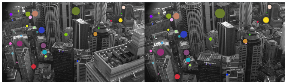
FIGURE 6.8 – Exemple d'appariements corrects de points d'intérêts. A chaque paire de points appariés, on a associé une couleur. Les tailles des cercles représentent l'échelle à laquelle les points ont été détectés.
