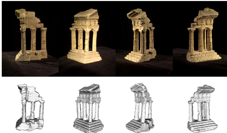
FIGURE 2.18 – Stéréovision multi-vues par level-set. Haut : extrait du jeu de données (temple). Bas : temple reconstruit avec angles de vues correspondants. Le jeu de données contient 24 images de 256 \times 256 pixels. La reconstruction s'effectue en 420s sur GPU, contre 1550s pour une version CPU. Issu de [128].
